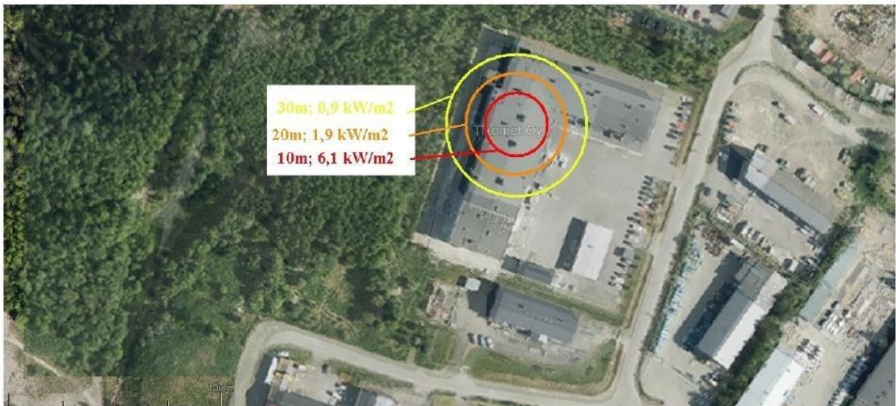
Kuva 2: Lämpösäteilyn vaikutukset esitetty tuotantotilassa tapahtuvassa laajassa tulipalossa
